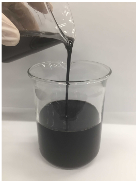
写真 バインダー添加長尺カーボンナノチューブ分散液（左）、帯電防止膜試作品（右）
