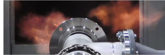
図 2 Innova-Jet Swing Hydrogen 火炎 (0.4 MW, 水素 100%, CO 2 削減量 70 kg/h)
