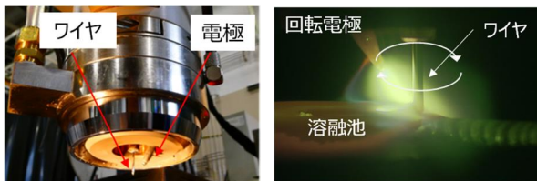
図 4 回転 TIG トーチの外観と金属積層状況
