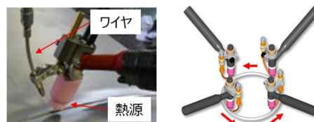
図 2 従来 TIG 溶接のトーチ形状と走行パスの例
