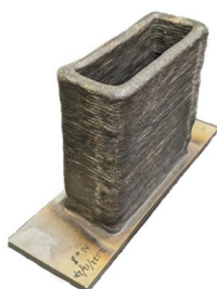
図 5 回転 TIG 溶接による積層造形サンプル
