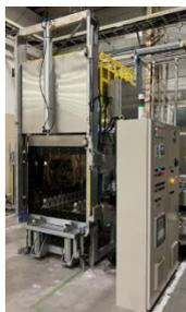
図 1 ワイドレンジ型液化窒素式サブゼロ装置
