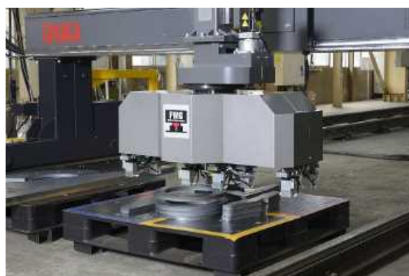
図4 ピッキング機によるパレットへの仕分けの様子
