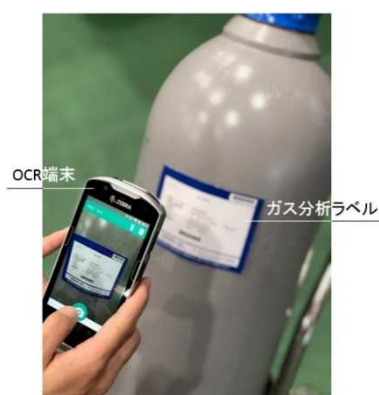
図2 入荷時の OCR ラベル読取り
