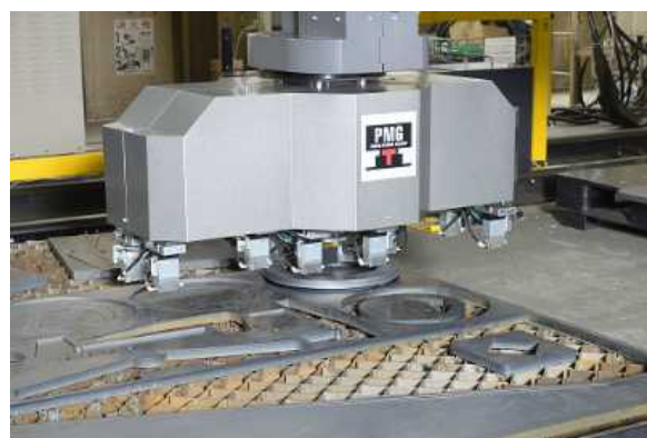
図3 ピッキング機による製品部材取り出しの様子
