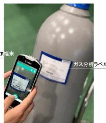
図2 入荷時の OCR ラベル読取り
