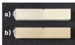
図 1 各種酸素濃度における造形物焼け具合 a)酸素濃度 5ppm b)酸素濃度 1500ppm
