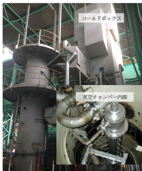
図 1 空気系低温蒸留実験装置
