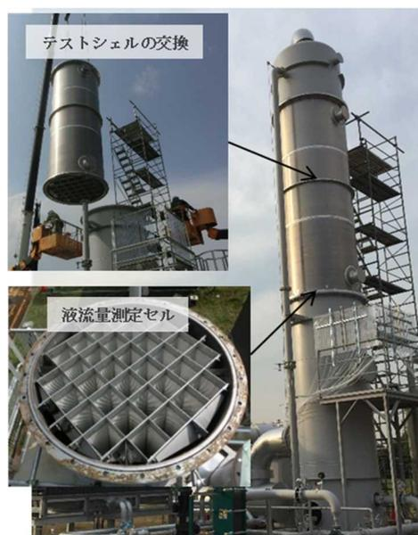
図 2 大型充填塔液分配試験装置
