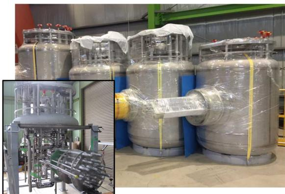
図 3 バルブボックス外観 (左下写真は内部配管)
