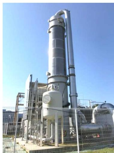
図1 大型充填塔液分配試験装置外観
