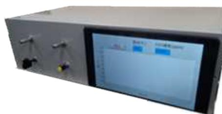
図 2 水分計試作機の外観
