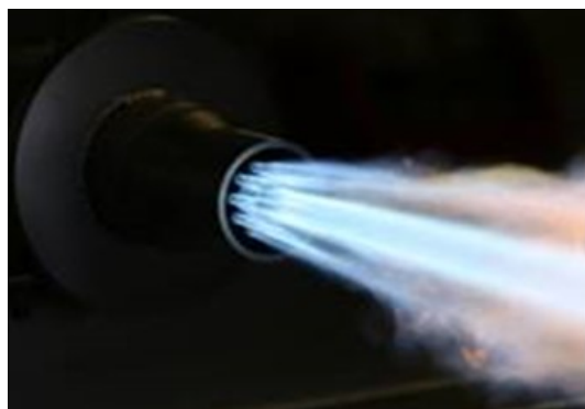
図5 非水冷式対流熱伝達型バーナ燃焼様子
