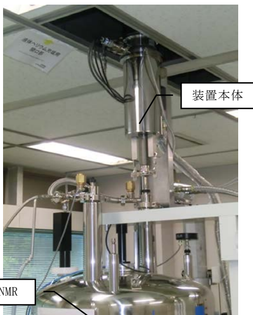
図1 NMR装置とHe蒸発抑制装置
