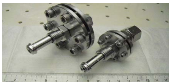
図 7. フィルターホルダー(組立) (左：既存品 右：検討品)
