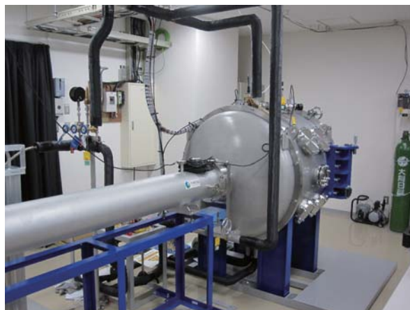
図1 火星探査試験用スペースチェンバー外観
