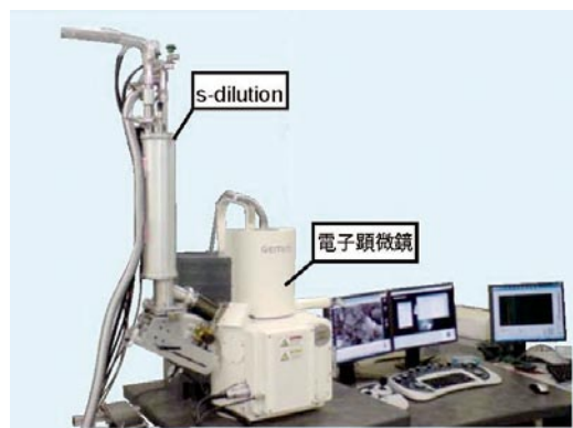
図 1 s-dilution と操作型電子顕微鏡 (SEM) を組み合わせた X 線分析システム
