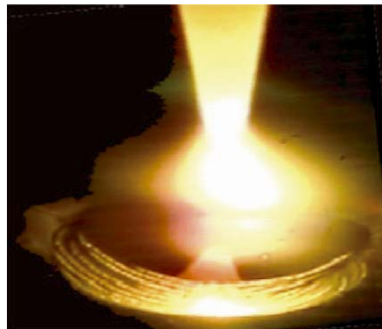
図 2 溶接中の溶融プール写真
