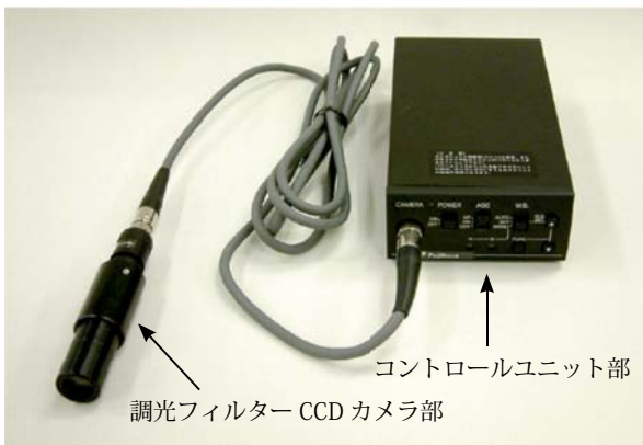
図 1 カメラシステム外観 (除くモニター部)
