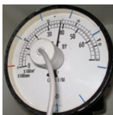
図1 差圧発信器なし残量（液面）計への設置例 （江藤酸素製 CE センサ（ECOM））
