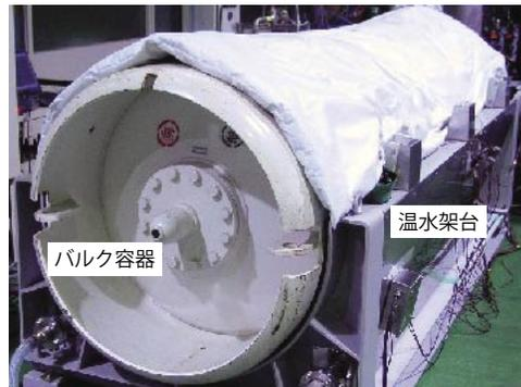
図5 温水架台とバルク容器
