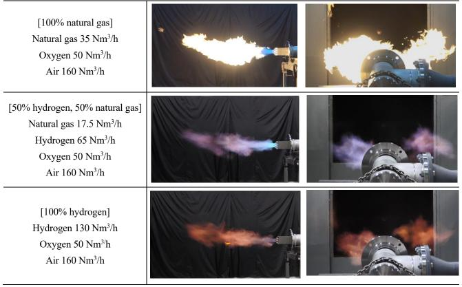
Fig. 3 Innova-Jet<sup>®</sup> Swing combustion flames
