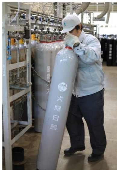
L G C 容器 ㊤ 及びボンベ容器運搬時の様子 (L G C 容器重量：約 300kg、ボンベ容器重量：約 50～80kg)
