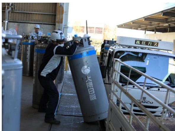
L G C 容器 ㊤ 及びボンベ容器運搬時の様子 (L G C 容器重量：約 300kg、ボンベ容器重量：約 50～80kg)
