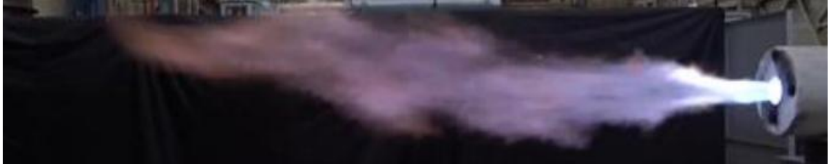
図 4 : 「Innova-Jet Hydrogen」の火炎 (燃料ガス : 天然ガス 50%/水素 50%、支燃性ガス : 酸素 100%)
