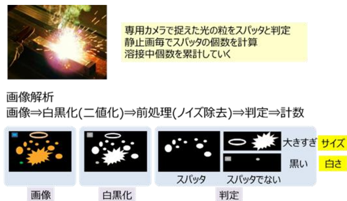
「サンアークスパッタカウンター」によるスパッタ計数手法
