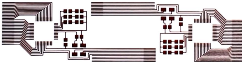
図2 インクジェット印刷機にて印刷した銅ナノインクの導電配線パターン
