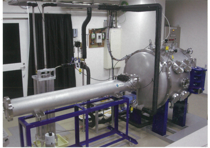
千葉工業大学 殿 火星探査試験用スペースチェンバー
