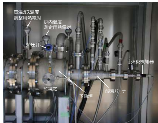
図 1 高温ガス発生装置の構造と外観
