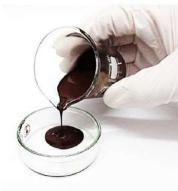
図3 銅ナノ粒子を用いた導電性インク外観
