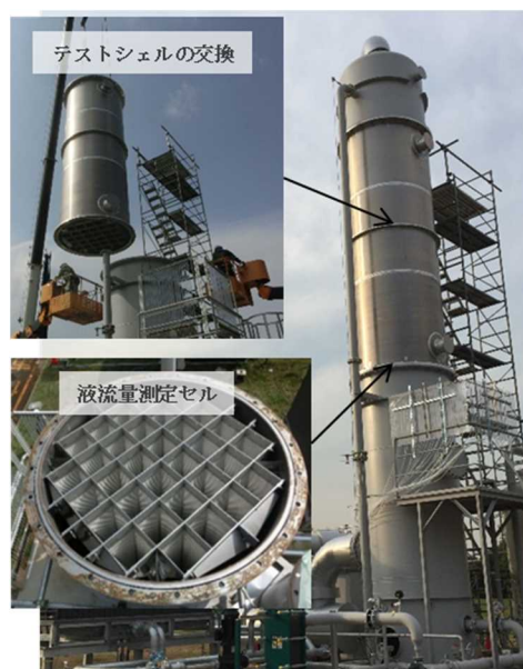
図 2 大型充填塔液分配試験装置
