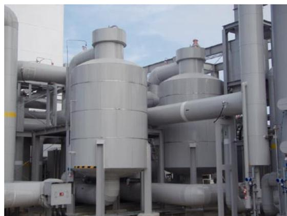
図3 実装置へ適用した高速流化前処理吸着器の外観
