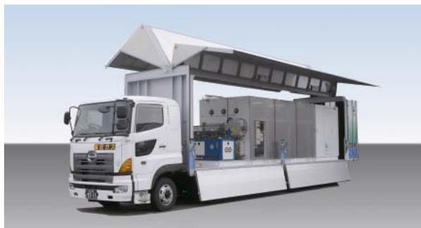
図2 ウィング開状態の移動式水素ステーション
