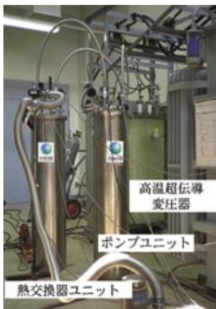
図2 バッチ式過冷却液体窒素冷却システム
